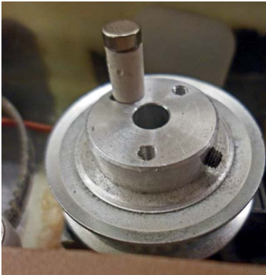
Zahnriemenscheibe und Stift mit Magnet
