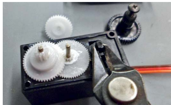
Entfernen der Achse des Potentiometers ▶
