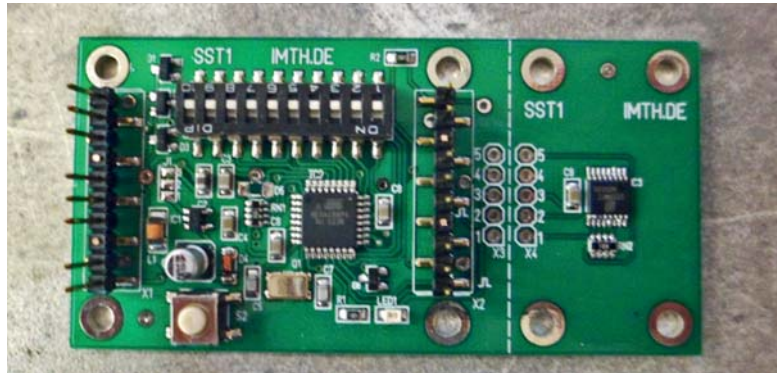
Die Platine mit Sensor; beachte die Markierung der Trennstelle
