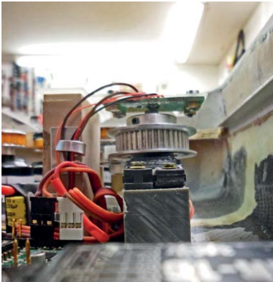
Auf der Drehachse des Servos ist ein Permanentmagnet angebracht
