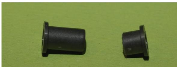
Bei der ersten Serie der Aluköpfe sind die Bohrungen für die Buchsen zu knapp und sollten auf 5,6 mm aufgebohrt werden bevor die Buchsen mit sanftem Druck von aussen eingesetzt werden.
