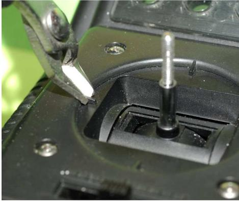
abkneifen der Nasen mittels Seitenschneider bei FC 16
