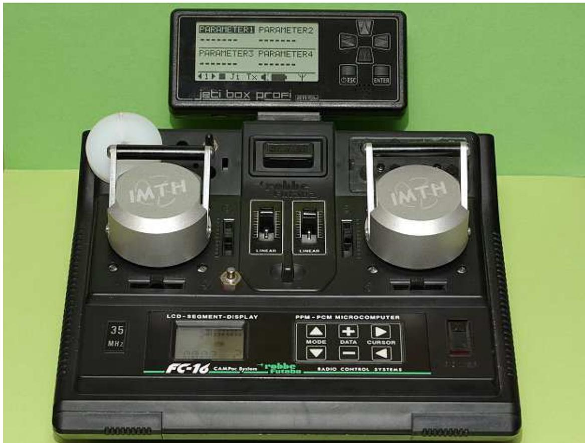
Montagesituation CoPilot auf FC 16: Passt und geht frei über Trimmhebel und Mittelschieber. Mit einem vertieft eingebauten Multiprop Encoder ist der CoPilot ebenfalls völlig frei beweglich.
