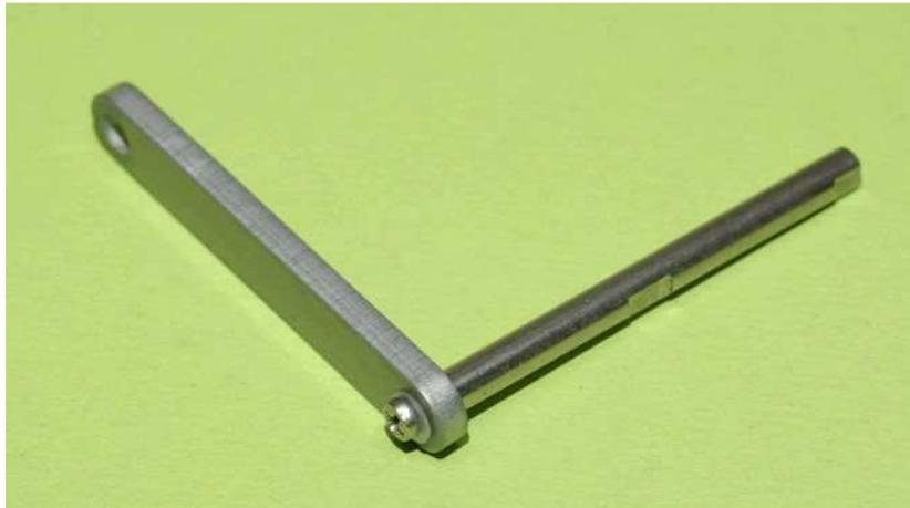
einen Aussenhebel mit der Achse verschrauben
